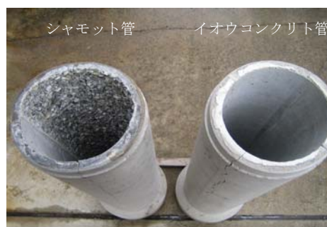
写真-4 30日間10%硫酸水溶液に暴露した状態
