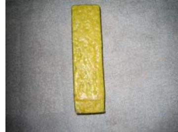
写真-1 イオウモルタルに浸漬した状態
