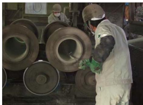
写真-3 イオウシャモットコンクリート管成形状況
