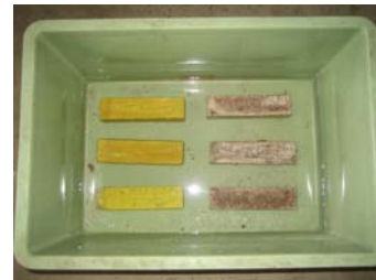
写真-2 10%硫酸水溶液に暴露した状態
